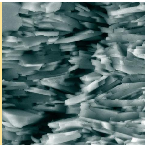
Figura 1. O fisură trebuie să se desfășoare în zig-zag prin plăcuțele stivuite din noua ceramică.
