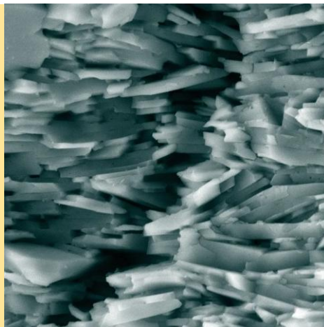
Εικόνα 1. Μια ρωγμή πρέπει να κάνει ζιγκ-ζαγκ μέσα από τα στοιβαγμένα αιμοπετάλια στο νέο κεραμικό.
