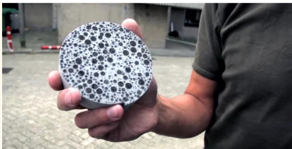
Κομμάτι του Bio Concrete (αυτοθεραπευόμενο σκυρόδεμα)
